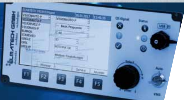
Vollautomatisches Punktschweißen mit Prozesssteuerung Virtuelle Maschine (VM3)
